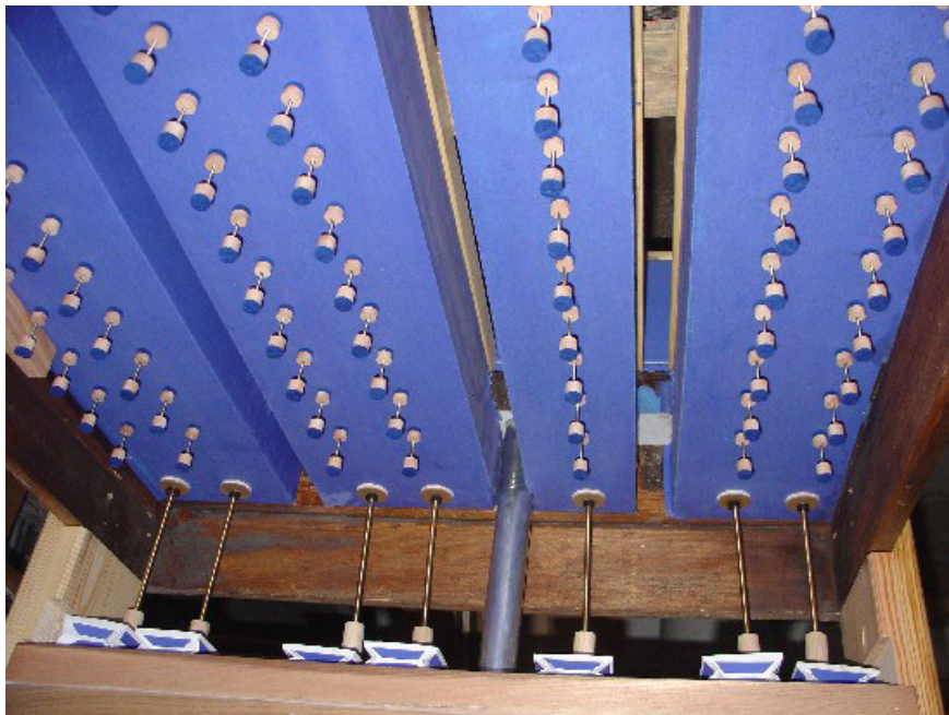
Wiatrownica widziana od dołu (tutaj brak urządzeń do unoszenia zaworków)
